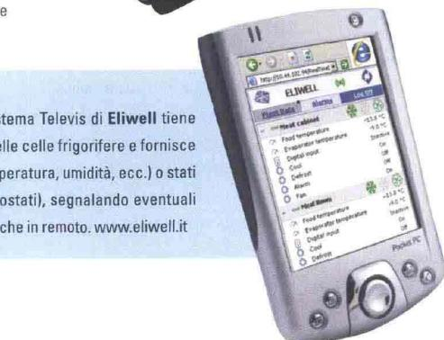
**MONITORAGGIO COSTANTE** Il sistema Televis di **Eliwell** tiene sotto controllo il funzionamento delle celle frigorifere e fornisce dati su grandezze analogiche (temperatura, umidità, ecc.) o stati logici (allarmi, micro-porta, pressostati), segnalando eventuali anomalie al computer collegato, anche in remoto. [www.elowell.it](http://www.elowell.it)
